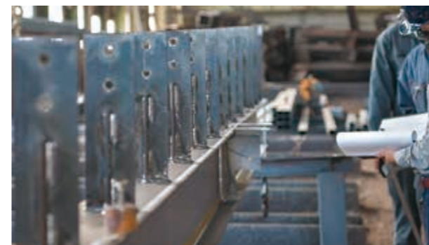
工場で溶接した束。1本ずつ高さが異なる
