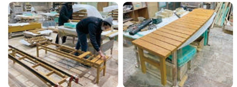
家具製作：座板を加工、組立、塗装（清藤木工）
